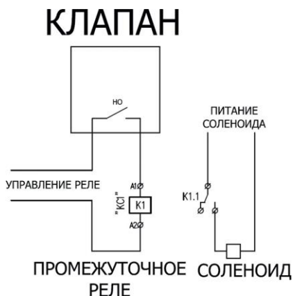
Рис.4 Схема подключения при подаче воды на COO
