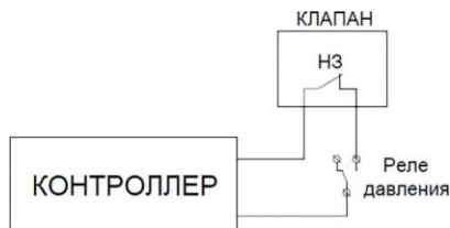
Рис.2 Схема подключения клапана в разрыв сухого хода
