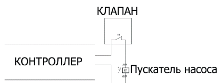
Рис.3 Схема подключения в разрыв питания
