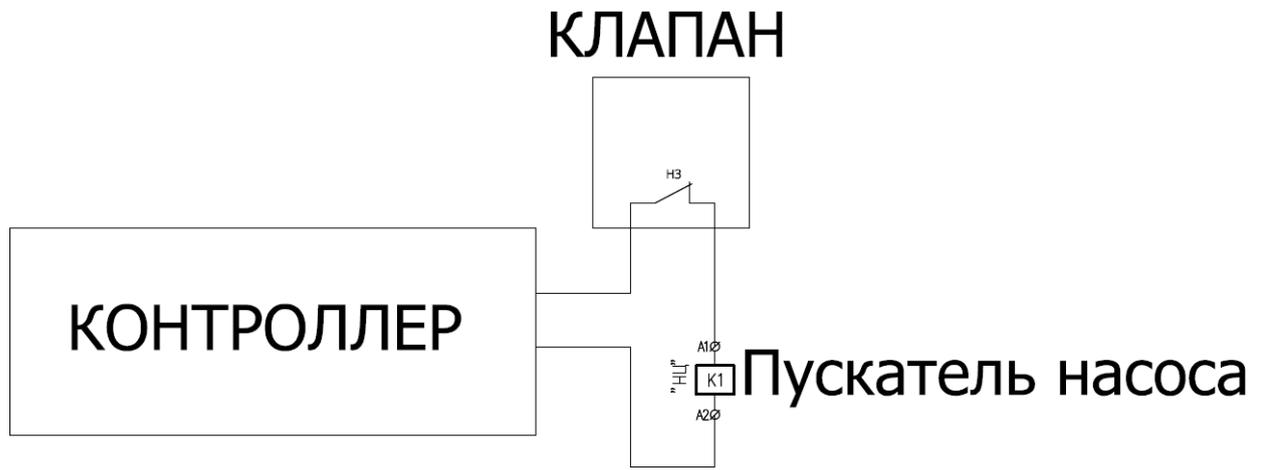
4. В том случае, если необходимо подавать воду на СОО при промывке фильтра. Можно использовать следующую схему подключения.
