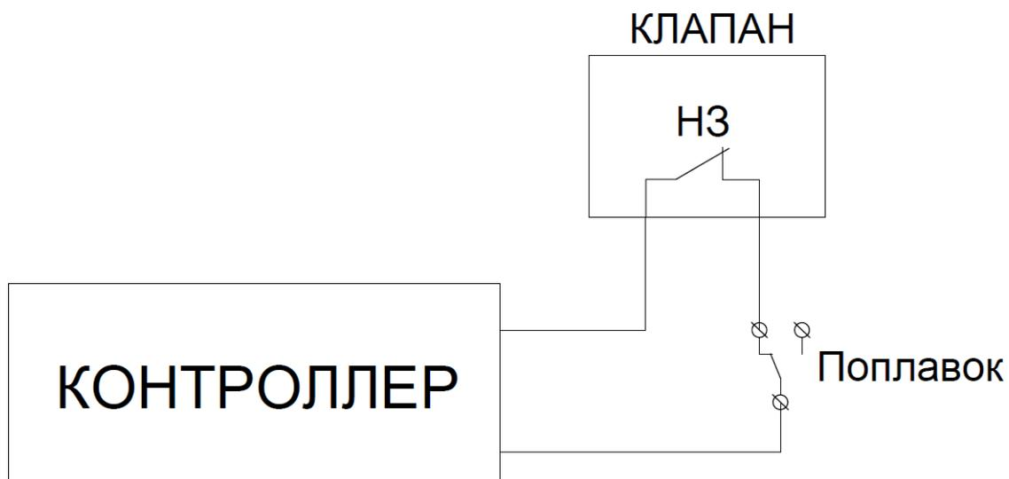
2.Подключение клапана в разрыв реле сухого хода. В данном случае будет имитироваться сухой ход, и СОО будет отображать ошибку. После завершения промывки цепь замкнется, ошибка «сухой ход» пропадет и СОО продолжит работу. Внутренний счетчик наработанных часов НЕ будет обнуляться.
