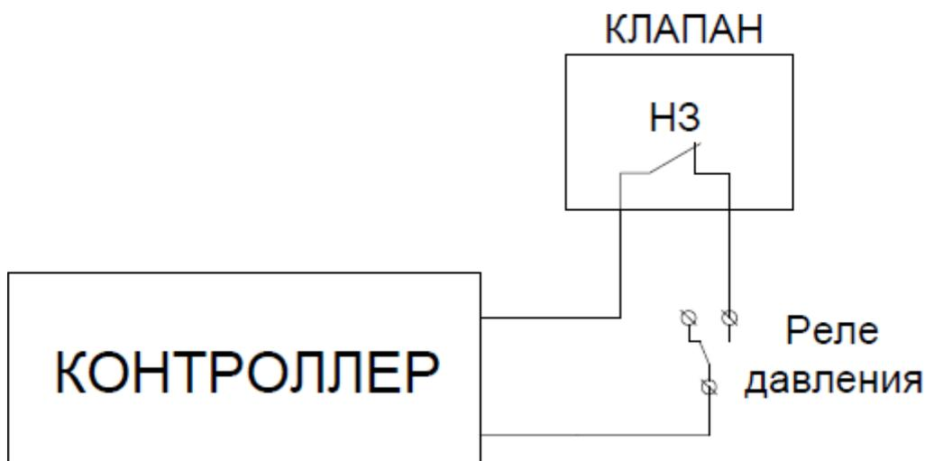
3.Подключить клапан в разрыв питания насоса. Данное подключение является более безопасным для насоса, так как отсутствует полностью возможность «сухого хода», который негативно сказывается на узлах системы, в частности торцевом уплотнении. Внутренний счетчик наработанных часов НЕ будет обнуляться.
