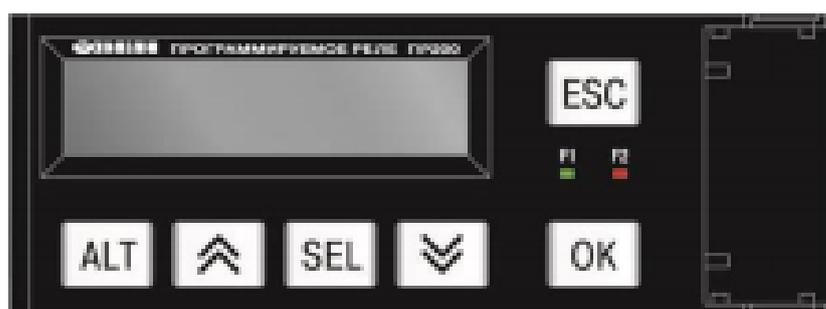
Используемая программа имеет три видовых экрана: *Главный*, *Настройки*, *Журнал*. Переключение между экранами осуществляется удерживанием кнопки ALT с нажатием кнопки ESC. Перелистывание строк на любом экране происходит при нажатии ↑ или ↓. Для начала ввода команд и данных используется кнопка SEL, подтверждение ввода нажатием кнопки OK, отмена ввода нажатием кнопки ESC.
