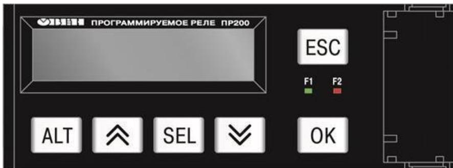
Контроллер имеет пять видовых экрана: экран загрузки, главный, экран ввода пароля, настройки, журнал.
