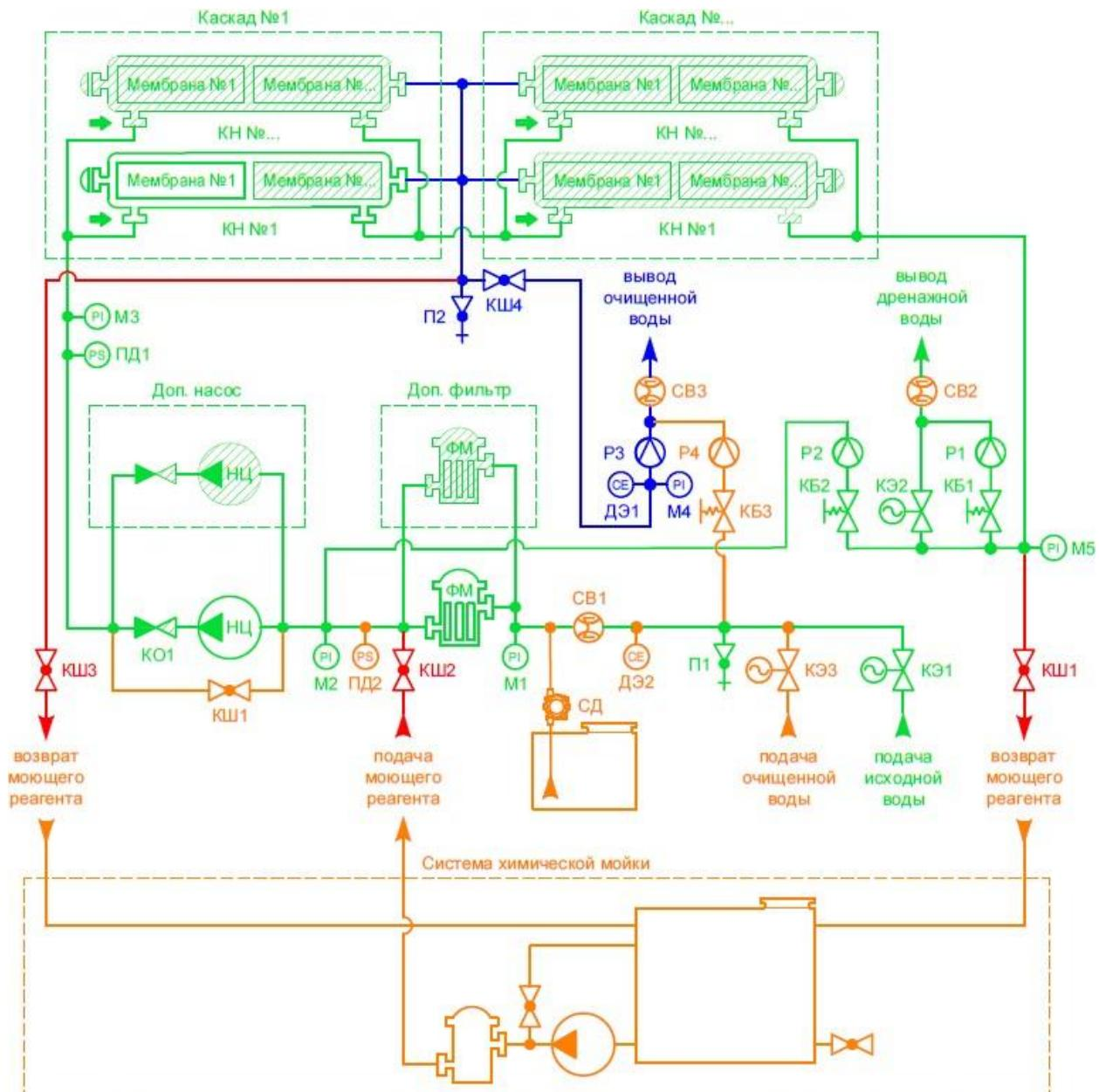
КН – корпус напорный, НЦ - насос центробежный, КБ - клапан балансировочный, ФМ - фильтр механический, КЭ - запорная арматура с электроприводом, Р - ротаметр, РД - реле давления / преобразователь давления, М - манометр, КО - клапан обратный, КШ - кран шаровый, СВ - счетчик воды, СД - станция дозирования.
